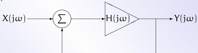
Zesílení smyčky oscilátoru je  $H(j\omega)$ . Nechť  $X(j\omega)$  reprezentuje poruchu a  $Y(j\omega)$  odezvu oscilátoru. Barkhausenova podmínka oscilací říká, že efektivní zisk smyčky musí být **jednotkový** a fázový posun se musí rovnat 360 stupňů pro oscilační frekvenci  $\omega_0$ . Přenosová funkce na poruchový stimul je
